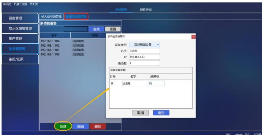
图26：设置终端设备的模拟音频输出设备
