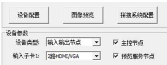
4. 拼接系统配置-选择主控设备-输出配置（按实际情况输入行数和列数）
