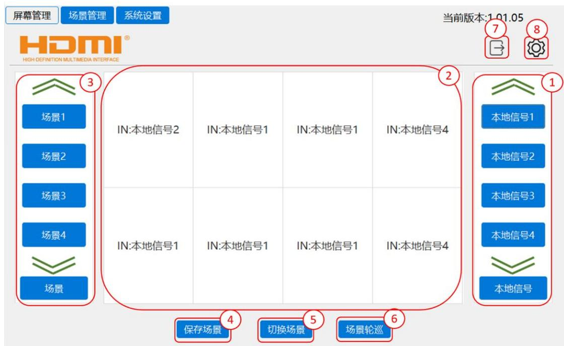
1、本地信号源列表：矩阵输入信号源列表，对应矩阵输入通道，选中“本地信号x”按钮，点击右键，弹出修改名称提示框，可以对“本地信号x”按钮重命名，名称限定为6个字符；点击上下
