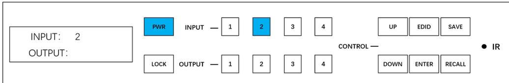
第二步：依次按OUT PUT区域2、3号输出通道按键，这2个输出按键指示灯亮蓝灯，显示屏上显示“OUTPUT：23 ”即可。
