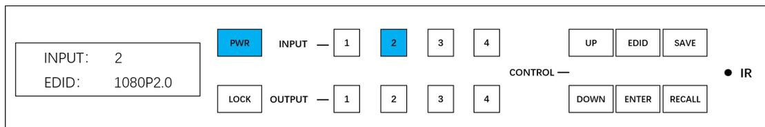
第二步：根据显示屏提示按“CONTROL”区域的“UP”或“DOWN”按键选择EDID数据，当显示屏上显示“EDID： 3D\_ \_ \_2.0”后，按“ENTER”按键确认，屏幕蓝屏然后恢复显示，完成EDID数据修改，再按“EDID”按键返回主页。
