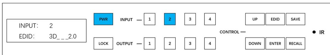
注：EDID列表中的OUT1-OUT4这4个选项（与矩阵输出通道数量一致，8进8出矩阵有8个OUT选项，16进16出矩阵有16个OUT选项），可以通过输出接口读取该输出接口所接的显示屏EDID数据，并将EDID数据导入对应的输入接口中（示例：如果修改2号输入接口的EDID数据时，选择OUT4选项，2号输入接口就会学习4号输出接口所接显示屏的EDID数据）。
